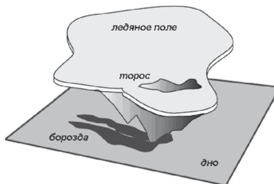
Рис. 7. Экзарация дна торосом, вмерзшим в дрейфующее ледяное поле, по [Marchenko et al, 2007]
