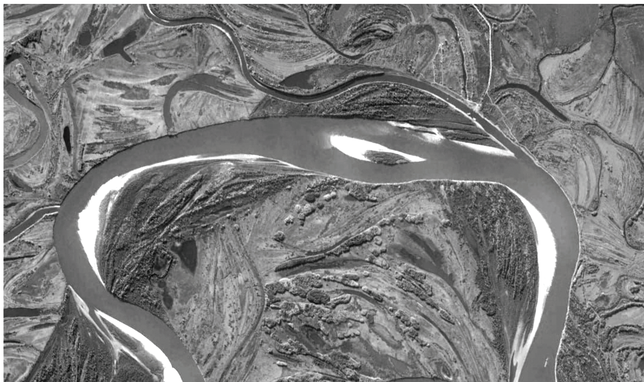
Рис. 5. Сундучная излучина в левом судоходном рукаве Канеровского разветвления средней Оби (ниже г. Колпашево) с островом в местном расширении русла
