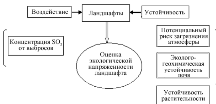
Рис. 1. Алгоритм оценки геоэкологического состояния ландшафтов при аэротехногенном загрязнении оксидами серы
