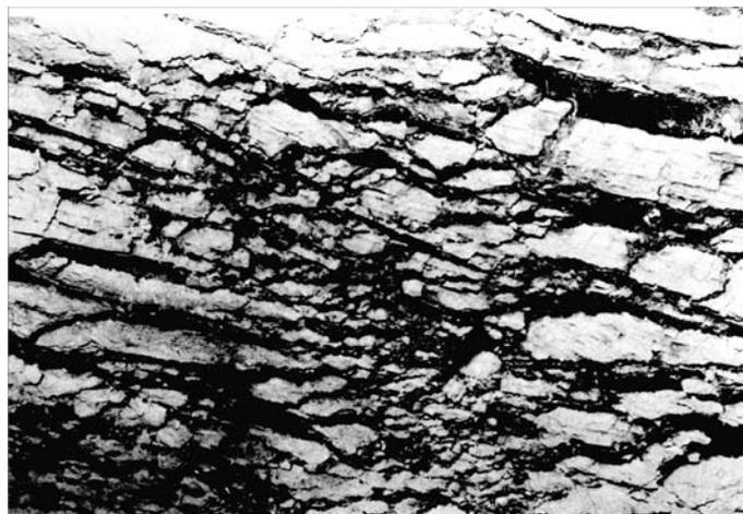
Рис. 3. Разрез мерзлой толщи ленточных глин (разные участки толщи), игарское подземелье. Видны крупные ледяные шпирьи (черное), разделенные широкими грунтовыми прослоями (светлые). Фото Е.Г. Карпова (вверху) и Л.А. Степаненко (внизу)
