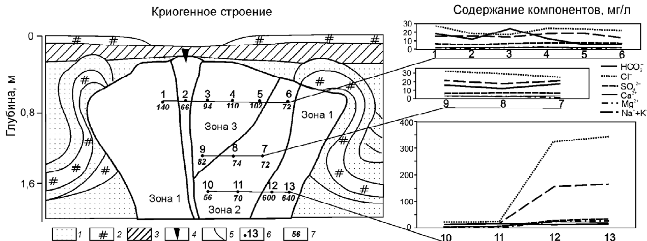
Рис. 2. Криогенное строение, минерализация и содержание ионов в полигонально-жильном льду в устье р. Монгаталянгыаха, п-ов Явай на севере Гыданского п-ова: 1 – песок, 2 – оторфованные горизонты, 3 – суглинок, 4 – росток современной жилки льда, 5 – жильный лед с разной общей минерализацией, 6 – точки отбора проб, 7 – содержание сухого остатка, мг/л
