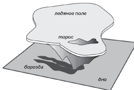
Рис. 7. Экзарация дна торосом, вмёрзшим в дрейфующее ледяное поле, по [Marchenko et al, 2007]
