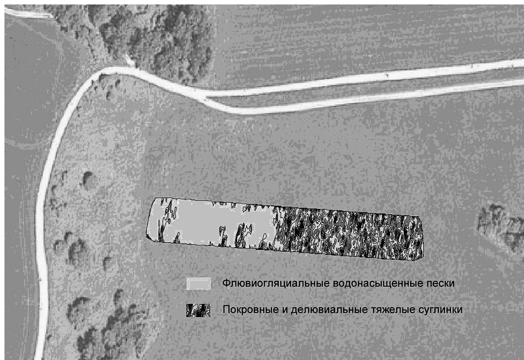
Рис. 3. Привязка границ линзы водонасыщенных лимногляциальных отложений, обнаруженных георадарной съемкой под покровными суглинками на склоне Сенокосной балки. Приведен горизонтальный срез площадной съемки на глубине 2,5 м (использован снимок Google Earth)
