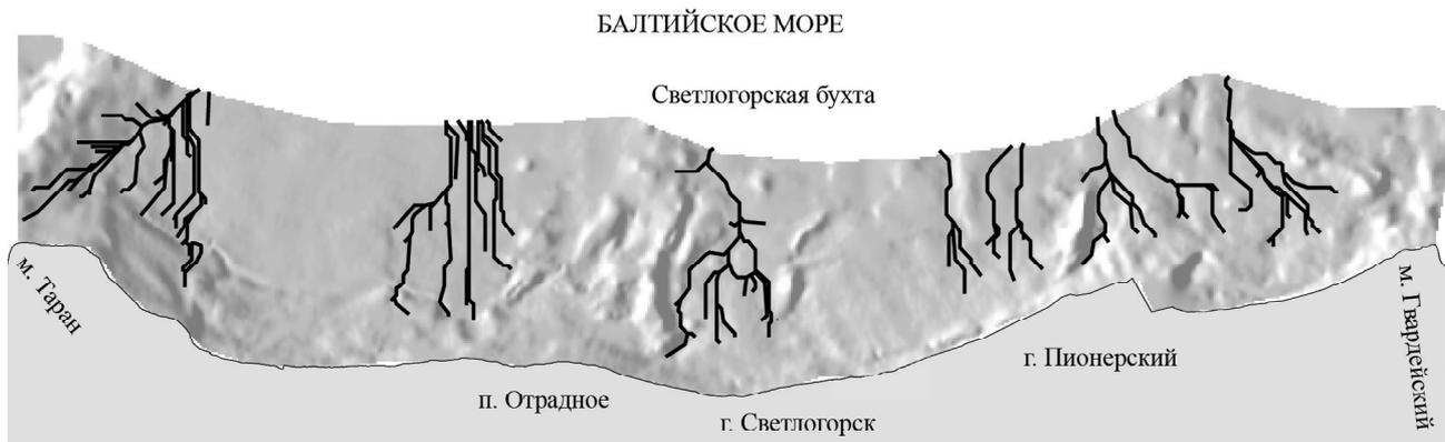
Рис. 4. Траектории наискорейшего спуска наносов для используемой цифровой модели рельефа в выделенных морфологических особенностях для района Светлогорской бухты
