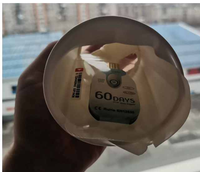
Рис. 2. Вид датчика с импровизированной радиационной защитой
